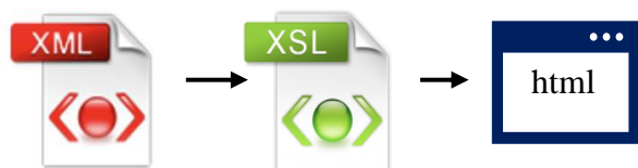
Figure 16 Schéma de transformation d'XMLs vers HTML
